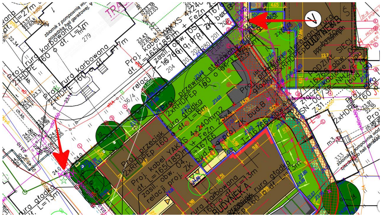
Ryc. 3. Lokalizacja komór startowej oraz końcowej przewiertu sterowanego
